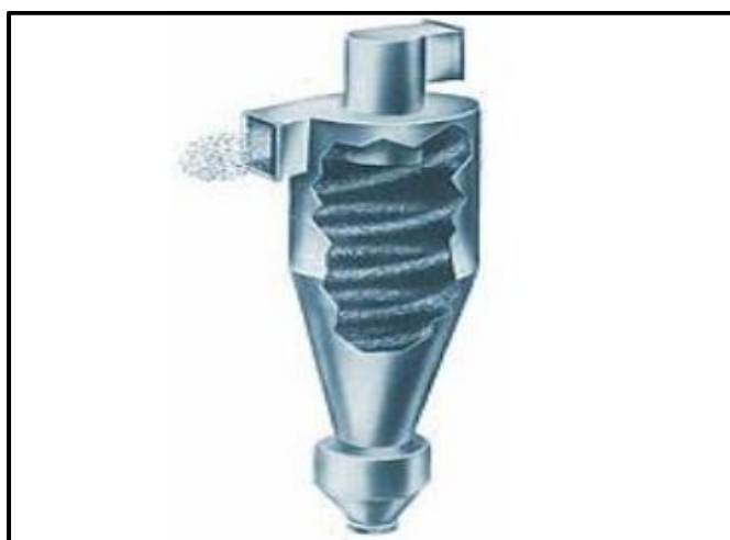
Figura 21 - Detalhe do funcionamento do ciclone.
