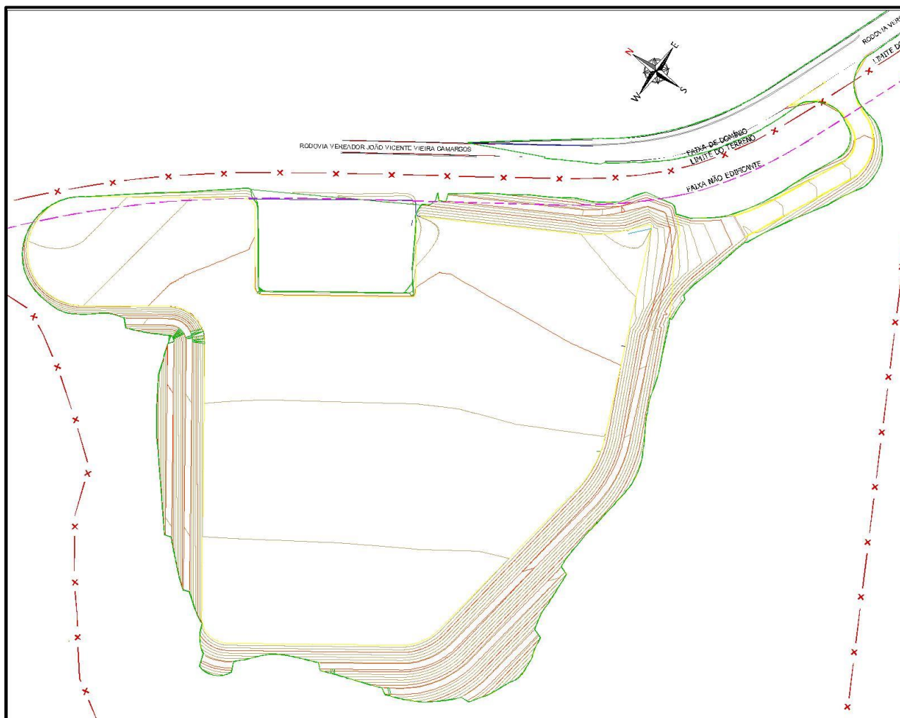
Figura 8 - Platô da terraplenagem e as saias do aterro.
